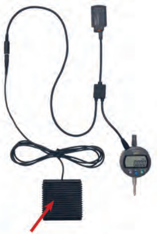
Кабель с ножным переключателем
