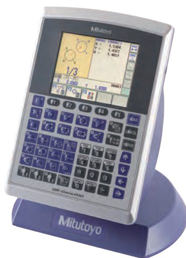
QM-Data 200 Блок для 2D вычислений
