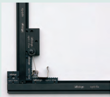
Зубчатая линейка позволяет проходить свету. Пружинный фланец фиксирует деталь в позиции, необходимой для измерения.
