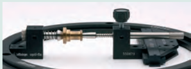
Удерживает цилиндрическую деталь между крепежными наконечниками.
