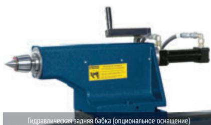
Гидравлическая задняя бабка (опциональное оснащение)
